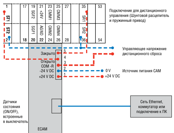
Вид сверху ECAM, смонтированного на IZMX
