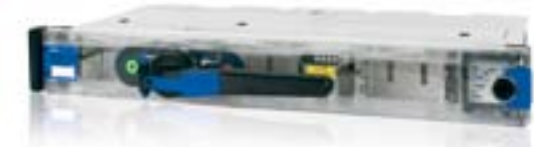
PIFT Выключатель с плавкими предохранителями Улучшает предохранительную технологию в производстве распределительных щитов и предлагает необходимую гибкость при помощи своего широкого типового ассортимента, модульной конструкции и простого расширения при переоснащении, убеждает исключительно высокой устойчивостью к коротким замыканиям до 120 кА при переменном токе 500 В, опциональный электронный контроль функций предохранителя и встроенная блокировка против включения.
