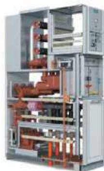
Power Xpert® FMX — комплектное распределительное устройство среднего напряжения с воздушной изоляцией и вакуумными автоматическими выключателями. Номинальный ток сборных шин 2000 А. Не содержит элегаз.
