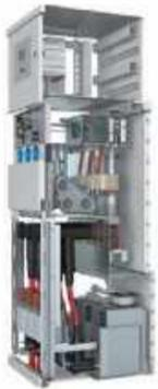
Xiria E — новое компактное распределительное устройство от компании Eaton. Xiria E предназначено для применения в распределительных сетях среднего напряжения и характеризуется высоким уровнем эксплуатационной безопасности. Комбинированная воздушная и твердая изоляция обеспечивает компактные размеры, а полностью закрытый металлический корпус исключает воздействие окружающей среды на работу первичных частей и механизмов.
