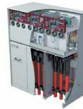
КРУ Xiria выполнено в виде моноблока и является одним из самых компактных распределительных устройств среднего напряжения в своем классе. Все первичные части и механизмы Xiria являются необслуживаемыми и располагаются в стальном герметичном баке, заполненном воздухом и герметизированном на весь срок службы. Отличительной особенностью Xiria также является использование компактных защитных реле взамен предохранителей.
