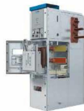
Комплектное распределительное устройство среднего напряжения Power Xpert® UX имеет воздушную изоляцию и выполнено на выкатных элементах. UX оснащается вакуумными автоматическими выключателями серии W-VACi. Номинальный ток сборных шин до 4000 А.
